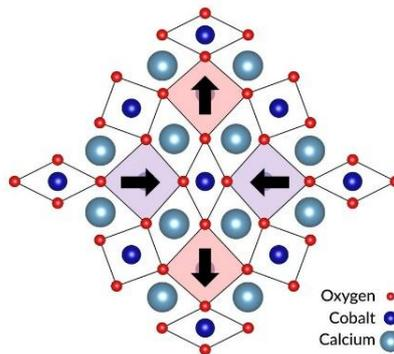
带负电荷的 Co 离子和带正电荷的 Ca 离子之间的电子拉锯战形成了量子材料中的扭曲。在 JT 效应中, 每个 Co 离子都试图从其上方和下方的层中拉出 Ca 离子, 以前所未有的方式向箭头方向扭曲原子晶格
